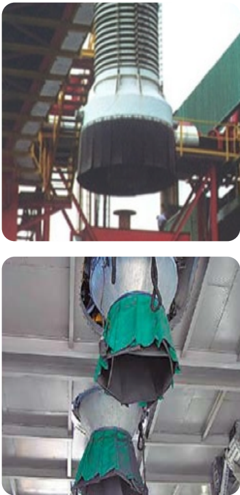
Figura 2.16 Mangas telescópicas de descarga. Las tres mangas permiten un llenado uniforme de la caja sin necesidad de mover el camión
