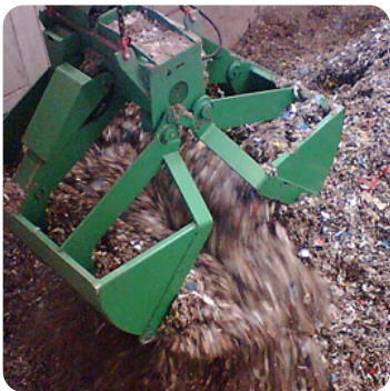
Figura 2.12 Operación de Descarga con cuchara
