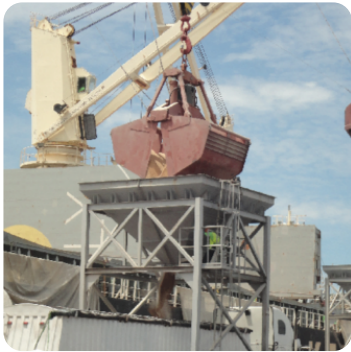
Figura 2.9 Sistemas de descarga mediante cuchara a tolva, Puerto Cortés Honduras
