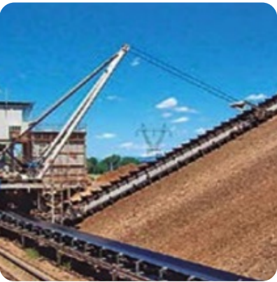
Levante de material mediante recogedor lineal de cadenas
