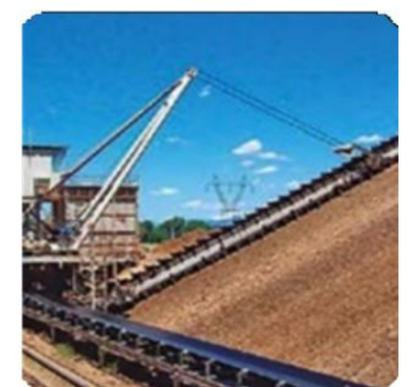
Levante de material mediante recogedor lineal de cadenas
