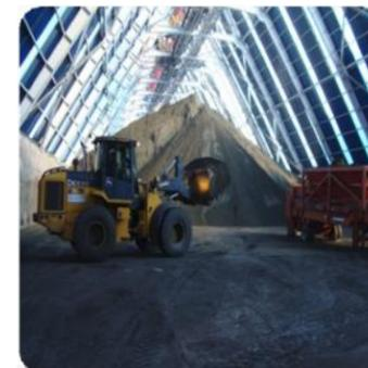
Figura 1.4 Manipulación Pilas Confinadas
