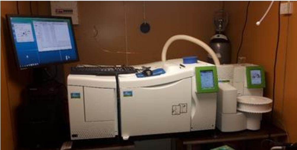
**Figura 63.** Un ejemplo de un cromatógrafo de desorción térmica- de gases-espectrómetro de masas
