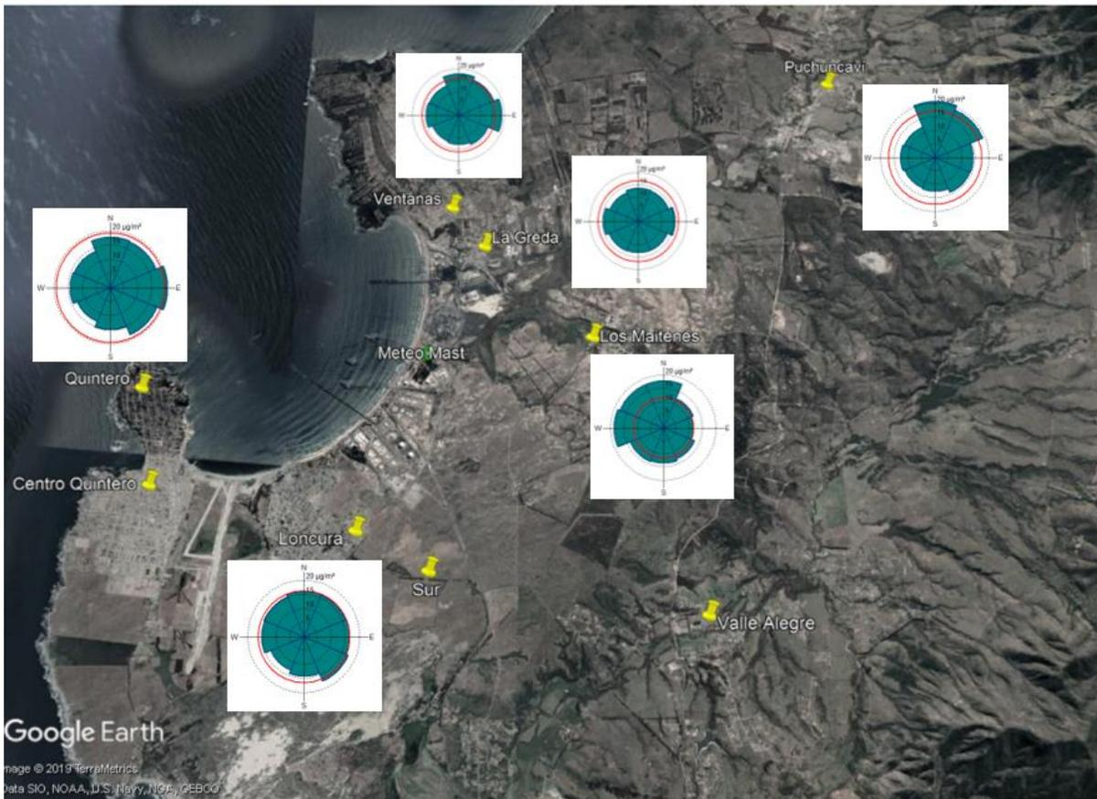
**Figura 14.** Rosas de contaminación por  $PM_{2.5}$  ( $\mu\text{g}/\text{m}^3$ ) basadas en mediciones en 6 estaciones de monitoreo AQ en el área de Quintero-Puchuncaví. La rosa de contaminación indica de qué dirección del viento provienen las mayores concentraciones.
