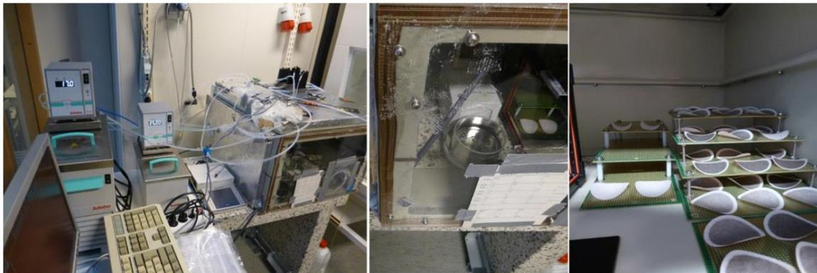
Figura 3: La caja de pesaje de los filtros y las unidades de control para el acondicionamiento de la temperatura y la humedad (a la izquierda) con la balanza (en la parte central) y la bandeja de filtros (a la derecha) (Walden et al, 2017).
