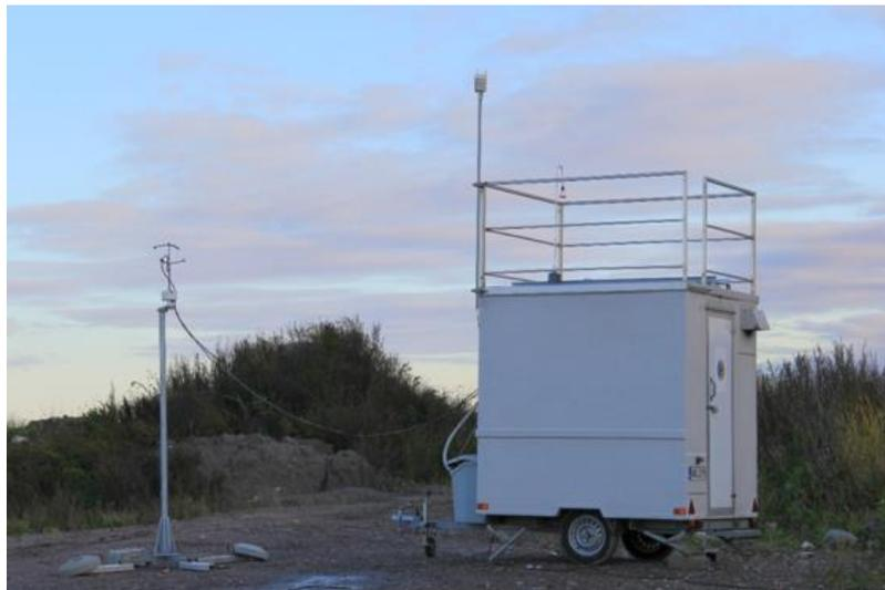
**Figura 58.** Cabina móvil de medición de calidad del aire que es fácil de desplazar entre diferentes lugares de medición.
