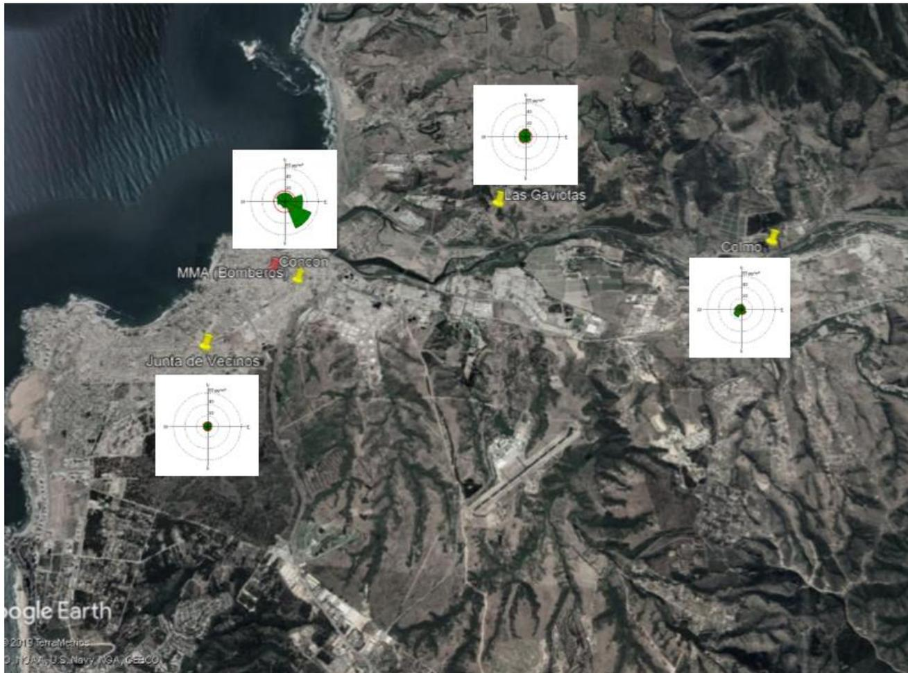
**Figura 41.** Valores promedio por hora de  $\text{SO}_2$  presentados como rosas de concentración en diferentes direcciones de viento en cuatro estaciones de calidad del aire durante 2016-2018. Las rosas de concentración indican de qué dirección del viento provienen las mayores concentraciones.
