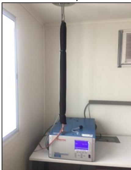
**Instalación de Equipos:** Algunos equipos se encuentran instalados sobre distintos tipos de mobiliario y materiales que en ocasiones no parecen ser lo suficientemente estables. Los equipos se observan funcionando adecuadamente, sin embargo, se sugiere revisar de manera periódica los filtros de ventilación de los equipos analizadores. Se observa que al menos una estación (Centro Quintero), mantiene equipos de respaldo para reemplazo de analizadores en caso de falla.
