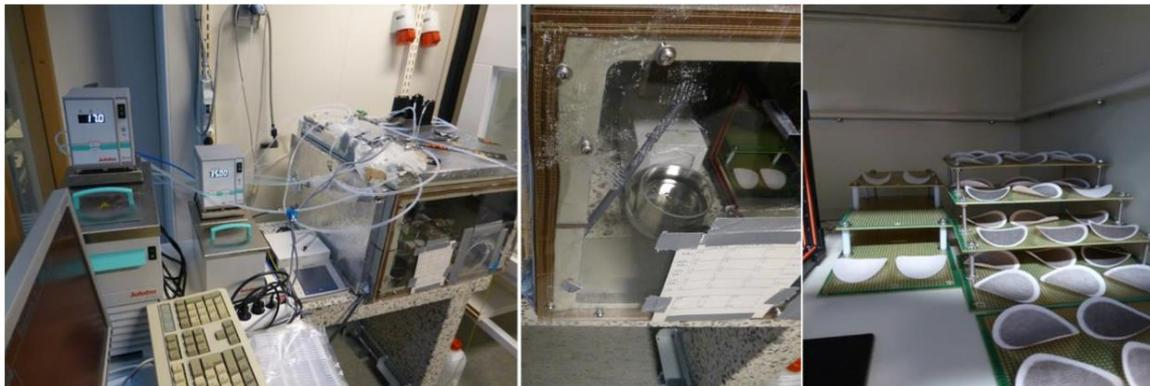
Figura 2. La caja de pesaje para los filtros y las unidades de control para acondicionamiento de temperatura y humedad (a la izquierda) con la balanza (en la parte superior central) y la bandeja del filtro (a la derecha) (Walden et al, 2017)
