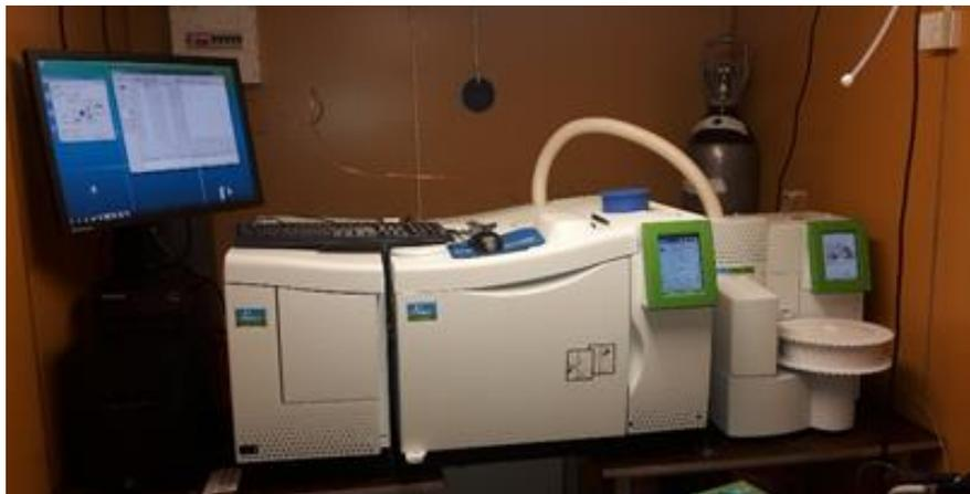
**Figura 14.** Un ejemplo de un cromatógrafo de desorción térmica de gases-espectrómetro de masas
