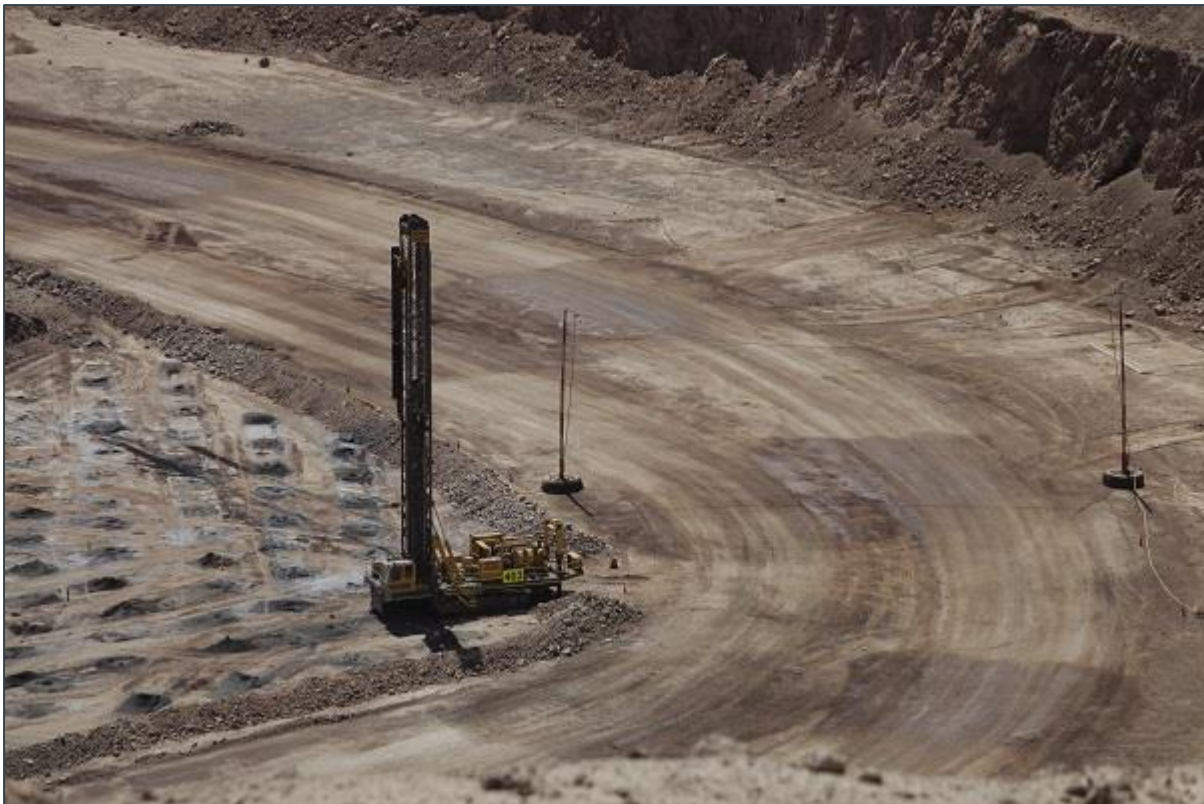
Figura 2. Pozos de perforación donde van los explosivos, etapa previa a la ejecución de una Tronadura.
